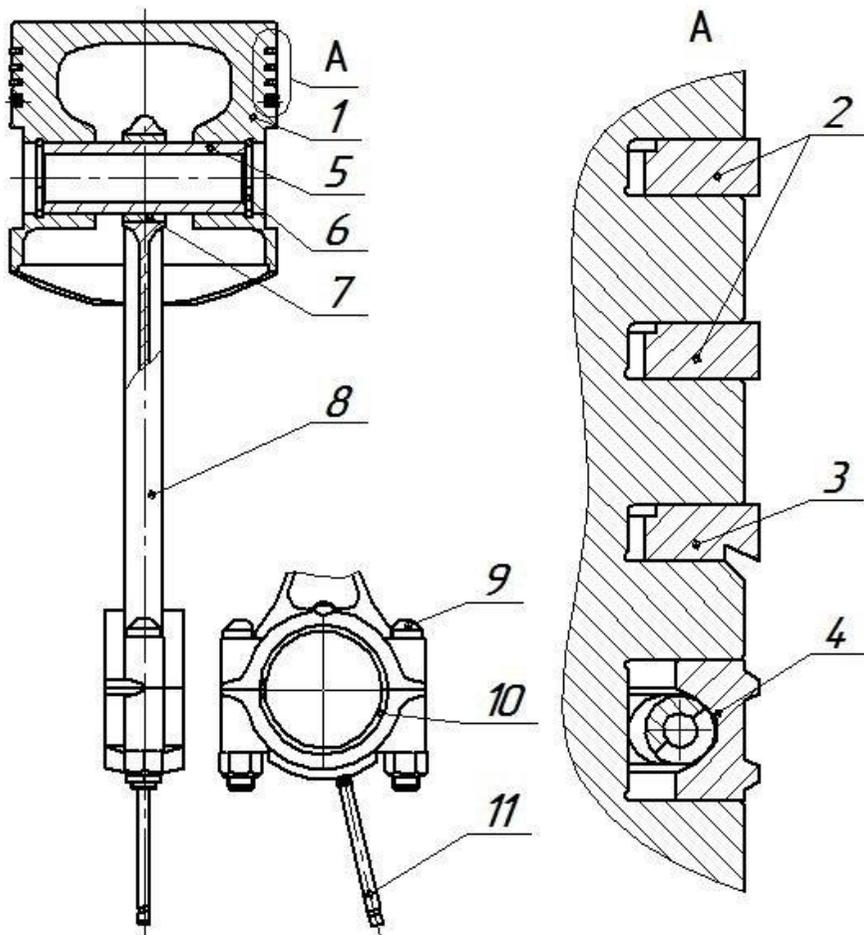
**Рис.4 Поршень цилиндра низкого давления первой компрессорной головки ( $\phi 108$  мм):**
