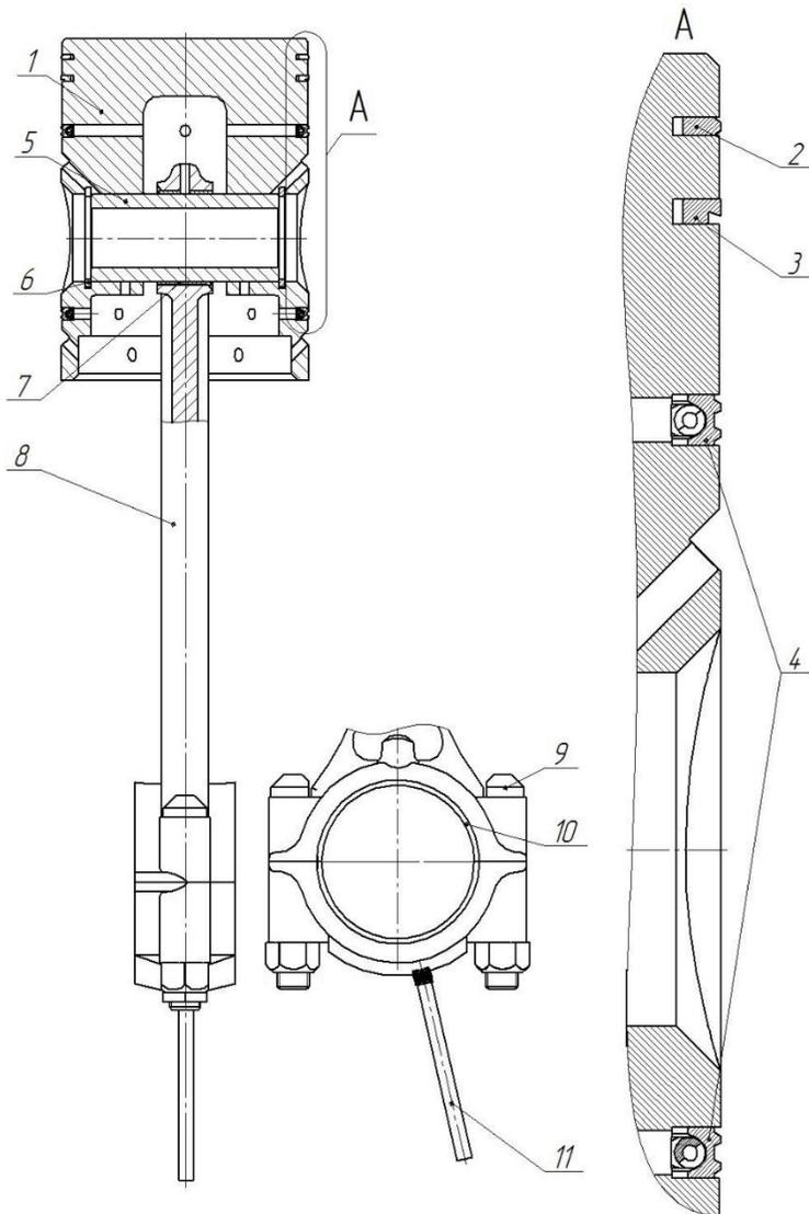
**Рис.6 Поршень цилиндра низкого давления первой компрессорной головки (φ79 мм):**
