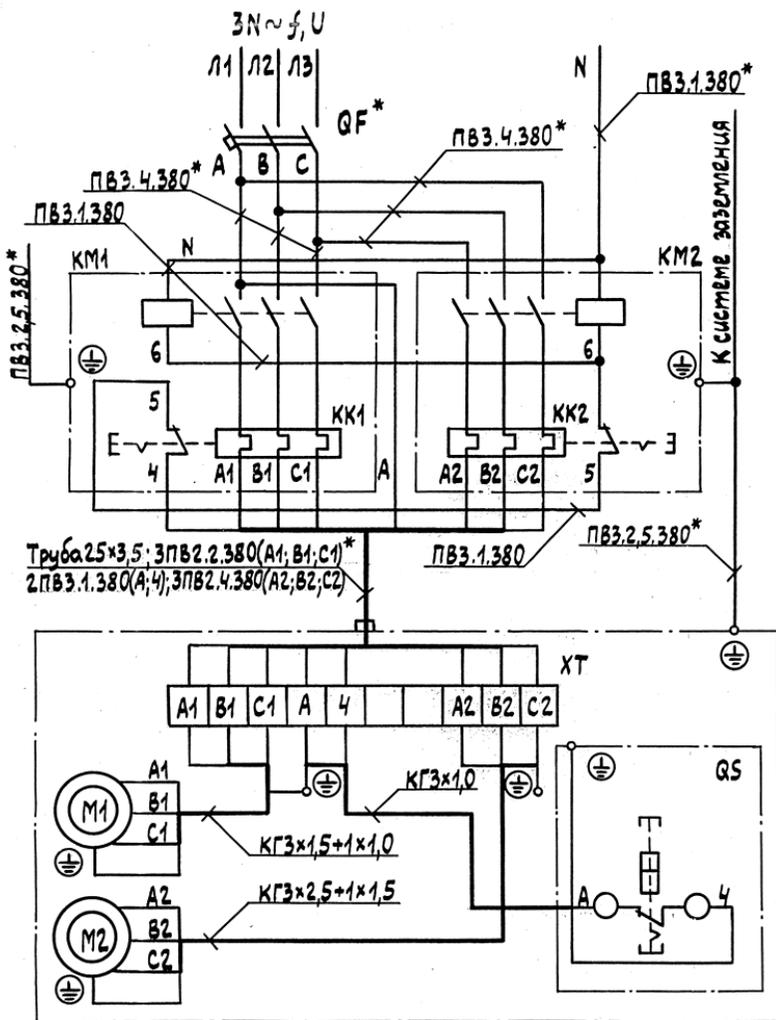
Рис. 14 Схема электрическая принципиальная и соединений установки К-33
