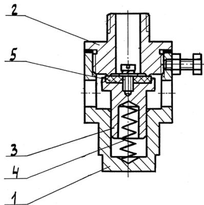
**Рис. 11 Обратный клапан**
