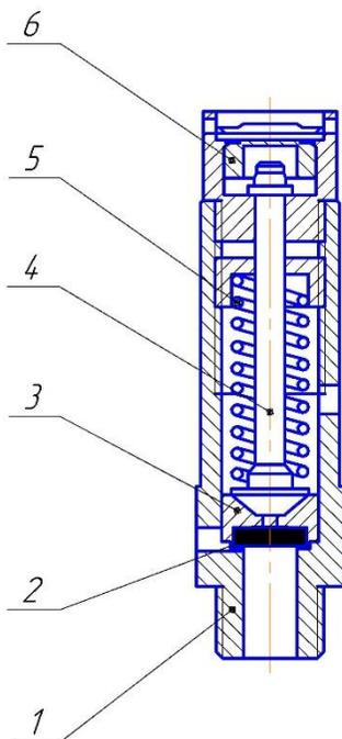
**Рис. 12 Клапан предохранительный на ресивере:**
