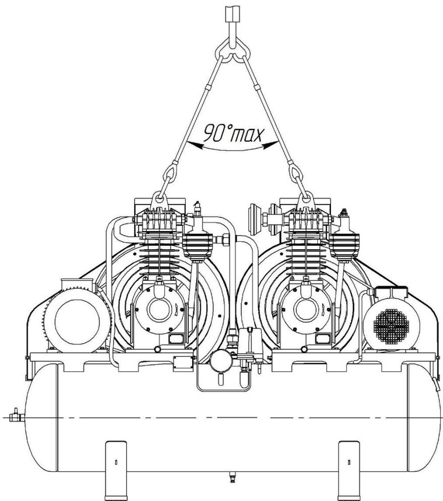
**Рис.15** Схема строповки установки компрессорной мод. К-33
