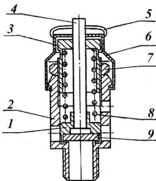
**Рис. 10 Клапан предохранительный на второй ступени сжатия:**
